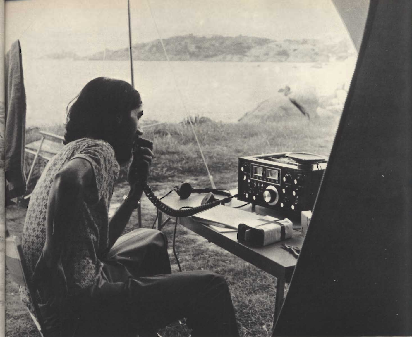
Fig. 2 - Una vista suggestiva di I2FGT al lavoro nell'accampamento di Caprera. In primo piano il «Transceiver» della Sommerkamp FT 150 con l'alimentazione incorporata sia per rete 220 V sia 12 V da batteria, utilissimo quindi alla spedizione.
