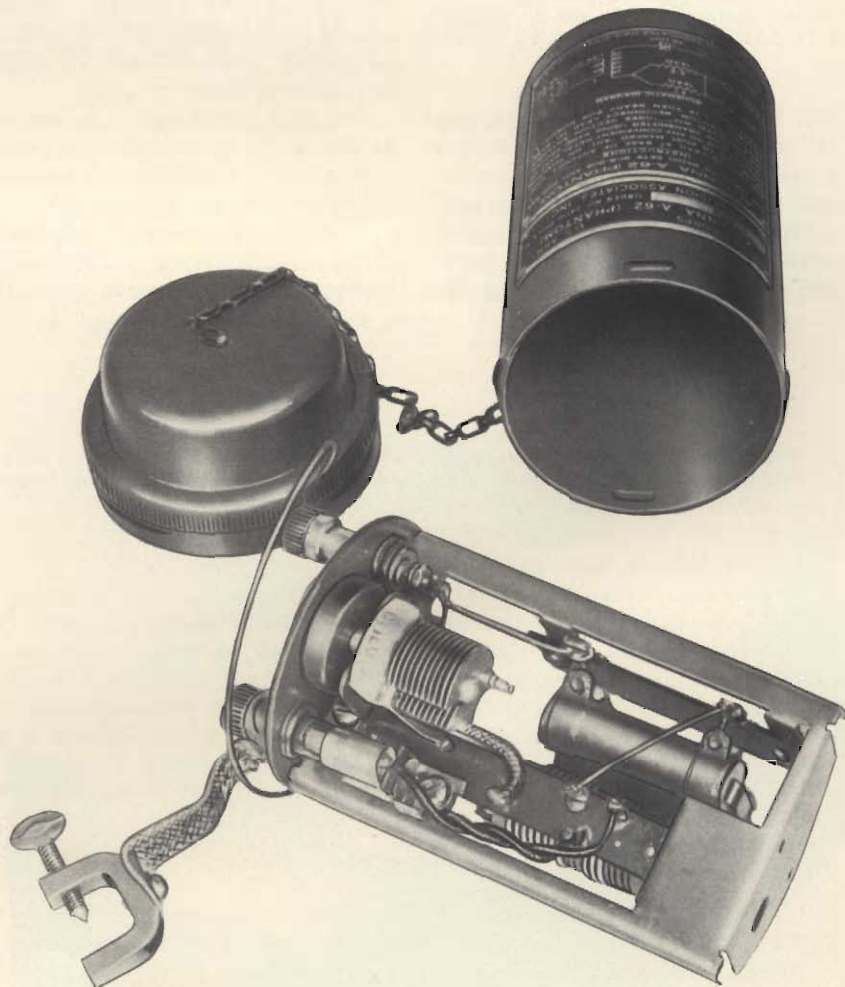
Fig. 4 - Vista della disposizione interna dei componenti e del contenitore di schermo con relativo coperchio.
